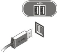
**Ilustración 8. Conexión USB**
